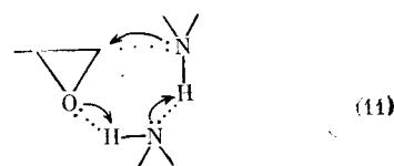
На основании имеющихся в настоящее время экспериментальных данных дискриминировать эти механизмы невозможно, однако нам представляется более предпочтительным второй (схема (11)), так как согласно этой схеме, реакция присоединения амина протекает через образование циклического переходного состояния и полностью завершается в один акт, тогда как при реализации схемы (9) необходимо осуществить еще перенос протона.
